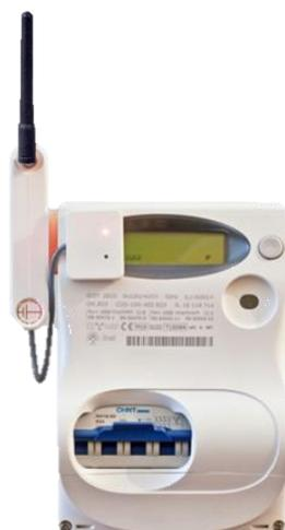
BOX di Monitoraggio con applicazione diretta al contatore tramite un sensore ottico per la lettura diretta dei lampeggi.
